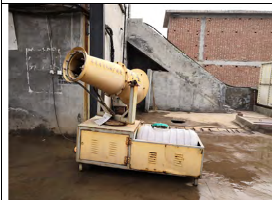
厂内环保除尘雾炮机
